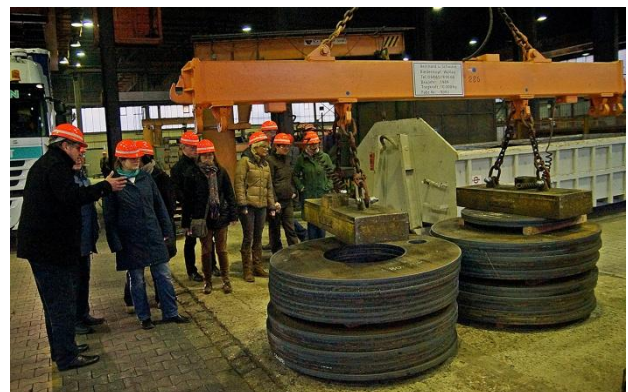
Mit Magnetkraft hebt der Kran die tonnenschwere Last.
